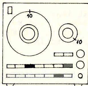
Koaksial-udgangen ⑦ tilsluttes et AC-digital-voltmeter. Trykknap-attenuatoren ⑫ sættes i stilling "1V". Den variable attenuator ④ stilles på "10". Frekvensen indstilles til 1KHz.  $\sim/\mu$ -knappen indtrykkes. Med potentiometeret P5 justeres udgangsspændingen til 1,11V. Et digital-voltmeter mäter normalt middelværdi og er kalibreret i sinus-effektivværdi, hvorfor der må tages hensyn til formfaktoren, 1,11. Såfremt digital-voltmeteret mäter effektivværdi, justeres udgangsspændingen til 1V.
