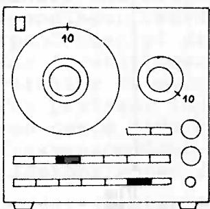
Koaksial-udgangen ⑦ tilsluttes et digital-voltmeter. Trykknap-attenuatoren ⑨ sættes i stilling "1V". Den variable attenuator ④ stilles på "10". Frekvensen indstilles til 1KHz (10Hz  $\times$  100).
