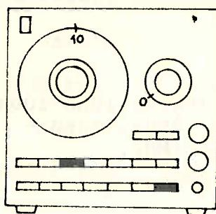
Trykknap-attenuatoren ⑫ sættes i stilling "3,16V". Den variable attenuator ④ stilles på "0". Frekvensen indstilles til 1KHz. Med potentiometeret P4 justeres spændingen over modstanden R68 til 50mV DC. Spændingen måles med et universalmeter, der tilsluttes direkte over modstanden.
