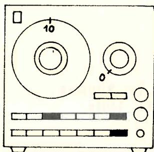
Koaksial-udgangen ⑦ tilsluttes et DC-voltmeter. Trykknap-attenuatoren ⑫ sættes i stilling "3,16V". Den variable attenuator ④ stilles på "0". Frekvensen indstilles til 1KHz.  $\sim/\mu$ -knappen indtrykkes. Med potentiometeret P7 justeres DC-offset-spændingen til 0V  $+\div 50\text{mV}$ .
