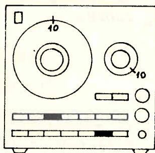
Koaksial-udgangen ⑦ tilsluttes et forvrængningsmeter, der kan måle forvrængning mindre end 0,03%. Trykknap-attenuatoren ⑫ sættes i stilling "1V". Den variable attenuator ④ stilles på "10". Frekvensen indstilles på 1KHz. Med potentiometeret P1 justeres til min. forvrængning. Med kabinetts svøb påmonteret kontrolleres, om forvrængningen stadig er mindre end 0,03%.
