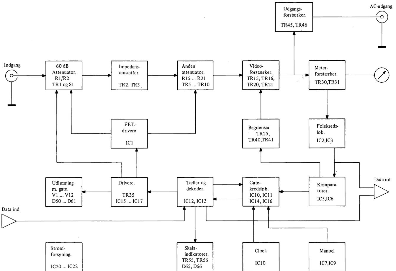
Fig. 4. Funktionsdiagram.
