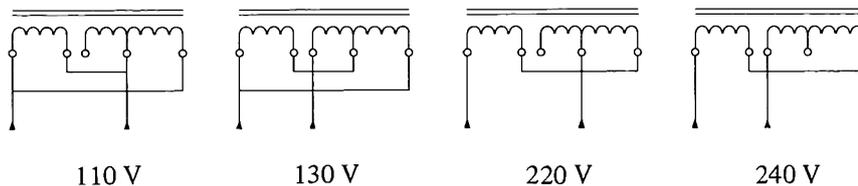
Fig. 1. Ændring til 110 V, 130 V eller 240 V netspænding.
